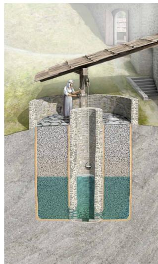
Die Filterzisterne: In den Fels wurde ein Tank gehauen, mit Lehm abdichtet und mit Sand verfüllt. Das darin eingeleitete Wasser wird beim Versickern gefiltert und kann aus dem inneren Schacht geschöpft werden. Zeichnung Joe Rohrer.
