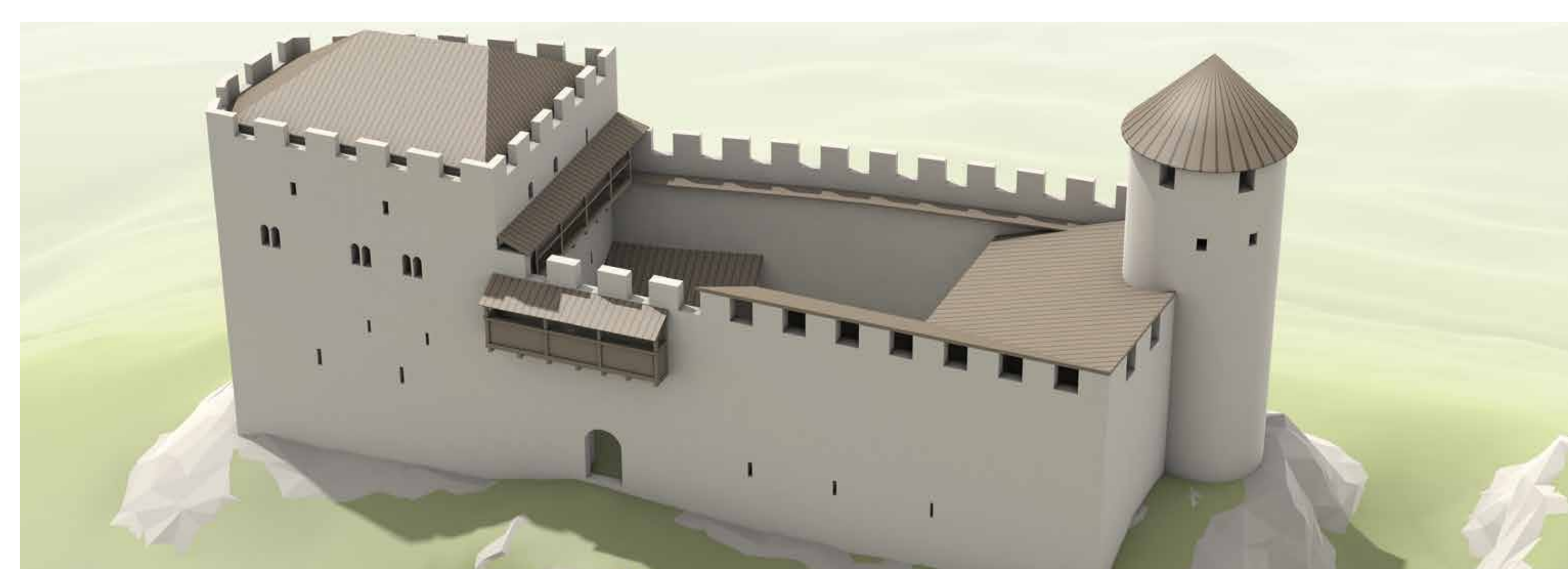
Zeichnerische Rekonstruktion der hinteren Burg auf dem Wartenberg von Osten. Schartenfenster sowie Unregelmässigkeiten im Mauerwerk weisen darauf hin, dass innen Gebäude an die Umfassungsmauer angebaut waren – zum Beispiel Unterkünfte für den Burgherrn und Bedienstete. Weiter sind Ställe für Schweine oder Pferde etc., Scheunen und Werkstätten, beispielsweise eine Schmiede, anzunehmen. Es wird sich sowohl um Stein- als auch um Holzbauten gehandelt haben. Zeichnung Joe Rohrer.
